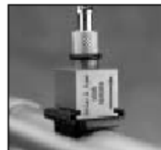
Рисунок 6. Установочный зажим с толстым основанием UA1475. Основание можно подпилить, чтобы подогнать его к форме установочной поверхности. Здесь показан зажим с акселерометром типа 4508, установленный на трубе.
